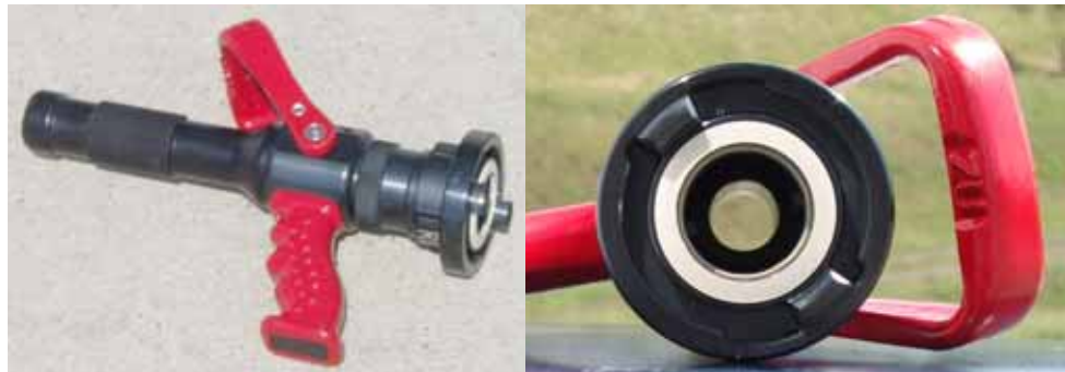
Bild 23: Die Runddüse als „CAFS“-Rohr – ideal für den Einsatz im Außenangriff bzw. für den Objektschutz im Außenbereich. Im Innenangriff mit Druckluftschaum ist nur ein Hohlstrahlrohr zu verwenden !
