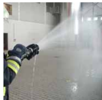
Bild 21: Unbefriedigendes Strahlbild bei 3 bar
